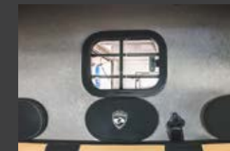
Okno posuvné s mříží mezi kabinou a prostorem pro koně
