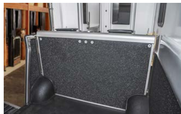
Vyjímatelná prsní stěna
